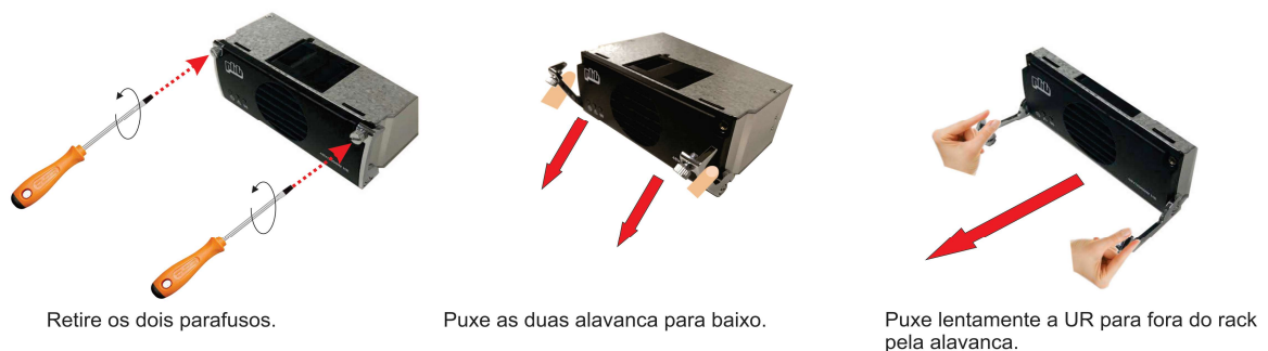
Figura 51a – Procedimento de desconexão da UR no sub-bastidor.
