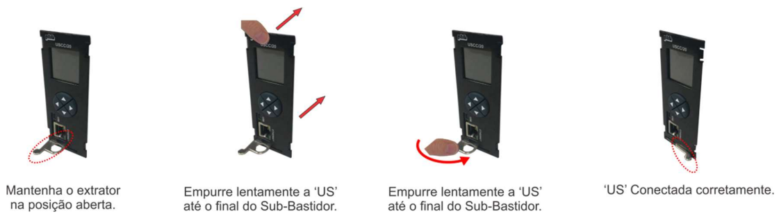
Figura 51c – Procedimento de conexão da US no sub-bastidor.
