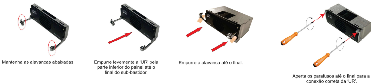
Figura 51d – Procedimento de conexão da UR no sub-bastidor.
