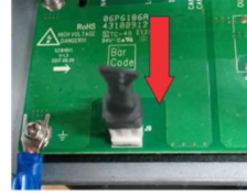
Conectar a terminação cabo CAN no conector 'J09' do SB19-1U/13.
